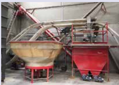
De zelfmenger van Dewicke bestaat uit een breker en een menger
